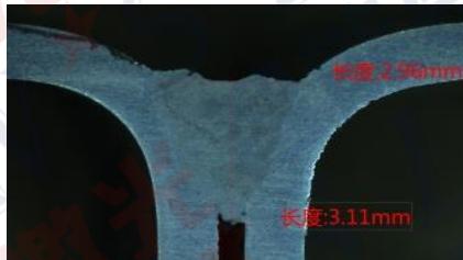
卷边对接焊缝+焊丝 材料：1.2mm6016+6016
